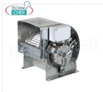
**Ventilatore centrifugo ad accoppiamento diretto, doppia aspirazione, portata max 1500 m³/h, V.230/1**
