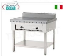
Cuocipiadina a gas su gambe con ripiano inferiore, piastra in acciaio da 600x600 per 4 piadine, potenza termica kw 6,7, dim.mm 650x730x960h
