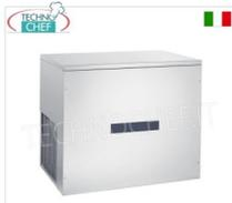
**Produttore di ghiaccio a cubetti pieni con sistema a spruzzo, da abbinare a contenitore per deposito ghiaccio, resa 300 Kg/24 ore, raffreddamento ad ARIA, V.230/1, Kw.2,7, dim.mm.1255x595x860h**
