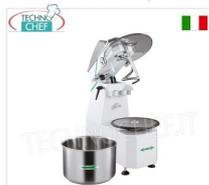
Impastatrice a spirale da 38 kg con testa sollevabile e vasca estraibile da lt 42, 1 Velocita', TRIFASE, V.400/3, kW 1,5, Peso 97 Kg, dim.mm.800x474x866h
