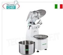
Impastatrice a spirale da 38 kg con testa sollevabile e vasca estraibile da lt 42, 1 Velocita', MONOFASE, V.230/1, kW 1,5, Peso 97 Kg, dim.mm.800x474x866h
