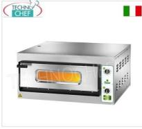
**FORNO per PIZZA ELETTRICO con 1 CAMERA da mm.660x995x140h, con PORTA VETRO, piano cottura in refrattario, 2 TERMOSTATI REGOLABILI per SUOLA e CIELO, temp.da +50° a +500 °C, Peso 93 Kg, V.400/3+N, kw 7,2, dim.esterne mm.900x1080x420h**
