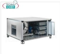
**CENTRALINA di Aspirazione, Filtraggio e DEODORIZZAZIONE con 36 CILINDRI di carbone attivo vegetale e 2 pre-filtri sintetici, portata max 12000 m/cubi/h, giri 897, V.400/3, Kw.4,00, Peso 380 Kg, dim.mm.1800x1280x1350h**
