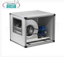
**ASPIRATORE CASSONATO con VENTILATORE CENTRIFUGO a TRASMISSIONE con CINGHIE e PULEGGE, pannellature INOX, 2 VELOCITA', portata max 4000/2657 m/cubi/ora, giri 1600/1063, db 72/62, V.380/3, Kw.1,7/0,6, Peso 59 Kg, dim.mm.800x620x620h**
