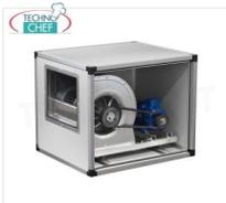
**ASPIRATORE CASSONATO con VENTILATORE CENTRIFUGO a TRASMISSIONE con CINGHIE e PULEGGE, pannellature INOX, 2 VELOCITA', portata max 2500/1673 m/cubi/ora, giri 1450/970, db 67/52, V.380/3, Kw.0,81/0,28, Peso 41 Kg, dim.mm.800x600x600h**
