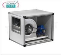
**ASPIRATORE CASSONATO con VENTILATORE CENTRIFUGO a TRASMISSIONE con CINGHIE e PULEGGE, pannellature INOX, 2 VELOCITA', portata max 10000/6736 m/cubi/ora, giri 800/539, db 69/59, V.380/3, Kw.3,0/0,9, Peso 114 Kg, dim.mm.1000x900x900h**
