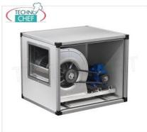
**ASPIRATORE CASSONATO con VENTILATORE CENTRIFUGO a TRASMISSIONE con CINGHIE e PULEGGE, pannellature INOX, 2 VELOCITA', portata max 8000/5389 m/cubi/ora, giri 1000/674, db 73/61, V.380/3, Kw.3,0/0,9, Peso 113 Kg, dim.mm.1000x900x900h**
