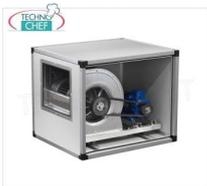
**ASPIRATORE CASSONATO con VENTILATORE CENTRIFUGO a TRASMISSIONE con CINGHIE e PULEGGE, pannellature INOX, 2 VELOCITA', portata max 5000/3322 m/cubi/ora, giri 1200/797, db 68/62, V.230/1, Kw.1,7/0,6, Peso 85 Kg, dim.mm.900x750x750h**
