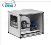
**ASPIRATORE CASSONATO con VENTILATORE CENTRIFUGO a TRASMISSIONE con CINGHIE e PULEGGE, pannellature INOX, 2 VELOCITA', portata max 5000/3322 m/cubi/ora, giri 1040/691, db 66/55, V.380/3, Kw.1,7/0,6, Peso 86 Kg, dim.mm.900x750x750h**
