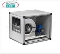
**ASPIRATORE CASSONATO con VENTILATORE CENTRIFUGO a TRASMISSIONE con CINGHIE e PULEGGE, pannellature INOX, 2 VELOCITA', portata max 3500/2325 m/cubi/ora, giri 1700/1129, db 69/59, V.380/3, Kw.1,7/0,6, Peso 59 Kg, dim.mm.800x620x620h**
