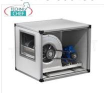
**ASPIRATORE CASSONATO con VENTILATORE CENTRIFUGO a TRASMISSIONE con CINGHIE e PULEGGE, pannellature INOX, 2 VELOCITA', portata max 9000/5979 m/cubi/ora, giri 810/538, db 69/59, V.380/3, Kw.2,2/0,75, Peso 113 Kg, dim.mm.1000x900x900h**
