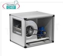
**ASPIRATORE CASSONATO con VENTILATORE CENTRIFUGO a TRASMISSIONE con CINGHIE e PULEGGE, pannellature INOX, 2 VELOCITA', portata max 7000/4715 m/cubi/ora, giri 1140/768, db 74/62, V.380/3, Kw.3,0/0,9, Peso 113 Kg, dim.mm.1000x900x900h**
