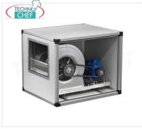
**ASPIRATORE CASSONATO con VENTILATORE CENTRIFUGO a TRASMISSIONE con CINGHIE e PULEGGE, pannellature INOX, 2 VELOCITA', portata max 3500/2342 m/cubi/ora, giri 1260/843, db 67/58, V.380/3, Kw.1,1/0,37, Peso 48 Kg, dim.mm.800x620x620h**
