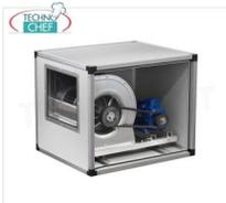
**ASPIRATORE CASSONATO con VENTILATORE CENTRIFUGO a TRASMISSIONE con CINGHIE e PULEGGE, pannellature INOX, 2 VELOCITA', portata max 2.000/1317 m/cubi/ora, giri 1440/948, db 65/52, V.380/3, Kw.0,55/0,18, Peso 40 Kg, dim.mm.800x600x600h**
