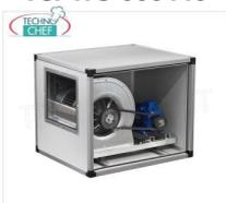
**ASPIRATORE CASSONATO con VENTILATORE CENTRIFUGO a TRASMISSIONE con CINGHIE e PULEGGE, pannellature INOX, 2 VELOCITA', portata max 7000/4650 m/cubi/ora, giri 1000/664, db 72/59, V.380/3, Kw.2,2/0,75, Peso 112 Kg, dim.mm.1000x900x900h**
