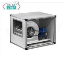
**ASPIRATORE CASSONATO con VENTILATORE CENTRIFUGO a TRASMISSIONE con CINGHIE e PULEGGE, pannellature INOX, 2 VELOCITA', portata max 7000/4650 m/cubi/ora, giri 1050/698, db 69/59, V.380/3, Kw.2,2/0,75, Peso 87 Kg, dim.mm.900x750x750h**
