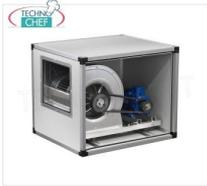
**ASPIRATORE CASSONATO con VENTILATORE CENTRIFUGO a TRASMISSIONE con CINGHIE e PULEGGE, pannellature INOX, 2 VELOCITA', portata max 4000/2676 m/cubi/ora, giri 1240/830, db 68/58, V.380/3, Kw.1,1/0,37, Peso 48 Kg, dim.mm.800x620x620h**
