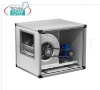
**ASPIRATORE CASSONATO con VENTILATORE CENTRIFUGO a TRASMISSIONE con CINGHIE e PULEGGE, pannellature INOX, 2 VELOCITA', portata max 6000/3986 m/cubi/ora, giri 1150/764, db 70/62, V.230/1, Kw.2,2/0,75, Peso 86 Kg, dim.mm.900x750x750h**
