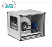
**ASPIRATORE CASSONATO con VENTILATORE CENTRIFUGO a TRASMISSIONE con CINGHIE e PULEGGE, pannellature INOX, 2 VELOCITA', portata max 8000/5315 m/cubi/ora, giri 830/551, db 68/55, V.380/3, Kw.2,2/0,75, Peso 113 Kg, dim.mm.1000x900x900h**
