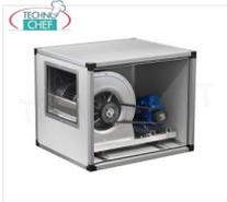
**ASPIRATORE CASSONATO con VENTILATORE CENTRIFUGO a TRASMISSIONE con CINGHIE e PULEGGE, pannellature INOX, 2 VELOCITA', portata max 4500/2990 m/cubi/ora, giri 1290/857, db 70/59, V.380/3, Kw.1,7/0,6, Peso 60 Kg, dim.mm.800x620x620h**
