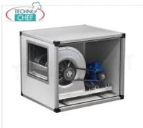
**ASPIRATORE CASSONATO con VENTILATORE CENTRIFUGO a TRASMISSIONE con CINGHIE e PULEGGE, pannellature INOX, 2 VELOCITA', portata max 8000/5389 m/cubi/ora, giri 1100/741, db 75/62, V.380/3, Kw.3,0/0,9, Peso 113 Kg, dim.mm.1000x900x900h**
