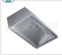
Cappa aspirante inox 430 a parete con Motore, con 3 filtri grasso a labirinto, V.230/1, Kw.0,147, Peso 74 Kg, dim.mm.1600x900x450h
